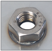
Mutterschweißen auf gelochte und ungelochte Bleche Nut welding onto punched and non-punched sheet metal
